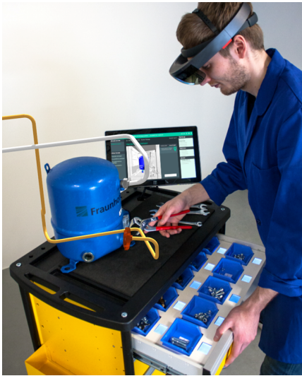
Abbildung 3: Plant@Hand Werkstattwagen mit Montageassistenzsystem
